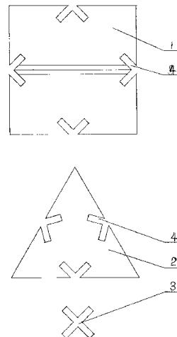
1.轻结构高强度快速组装的新型积木，该积木包括由多个设计成一定形状的基体，在基体上设计有不同形状的凹凸面，其凹凸面可与上述其它基体的凹凸面对插或交接，其特征在于：第一基体1为正方体，第二基体2为等边三角体，在第一基体1的六个平面与第二基体2的三个平面上设计有凹槽4，其中第一第二基体1、2平面对合时凹槽4所形成的结构形状与第三基体3的结构形状相同。
