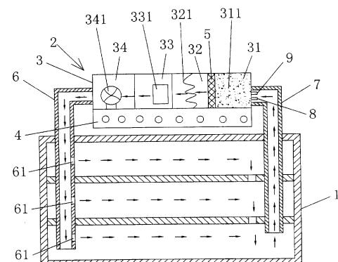
1、具有除臭、烘干、消毒功能的鞋柜，包括通用多层密闭式鞋柜和多功能处理盒，其特征在于：多功能处理盒分为循环通道和控制面板区两部分，多功能处理盒两端开有通孔与循环通道连通，循环通道内设有活性碳区、加热区、臭氧发生区和鼓风区，上述四个区两两互相连通；活性碳区内放置有活性碳，活性碳区与加热区之间设置有过滤网，加热区内放置有加热管，臭氧发生区内放置有臭氧发生器，鼓风区内放置有鼓风机；多功能处理盒一端与输气管的开口端连接，输气管的封闭端延伸到鞋柜的最底层，输气管在对应鞋柜每一层处开设有出气孔，多功能处理盒另一端与回气管的开口端连接，回气管另一开口端延伸到鞋柜内；控制面板区内设置有电路板，上述的加热管、臭氧发生器和鼓风机通过导线与电路板连接。
