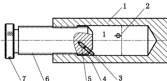
1. 一种盲孔螺套螺杆防拧出结构,其特征在于:由盲孔螺套(1)、盲孔(2)、限位销(3)、螺杆末端倒角(4)、限位销孔(5)、螺杆(6)、定位标记(7)组成,其中所述螺杆(6)装在盲孔螺套(1)内的盲孔内,限位销(3)装在限位销孔(5)中,限位销孔(5)打在螺杆末端倒角(4)上,所述螺杆末端倒角(4)与螺杆(6)轴线间的夹角在 $30^{\circ} \sim 60^{\circ}$ 之间,所述定位标记(7)作在螺杆(6)头部侧端,且与限位销孔(5)中心线在同一个平面上,同时盲孔(2)直径比盲孔螺套螺纹退刀槽直径大,二者之间形成一台阶差。
