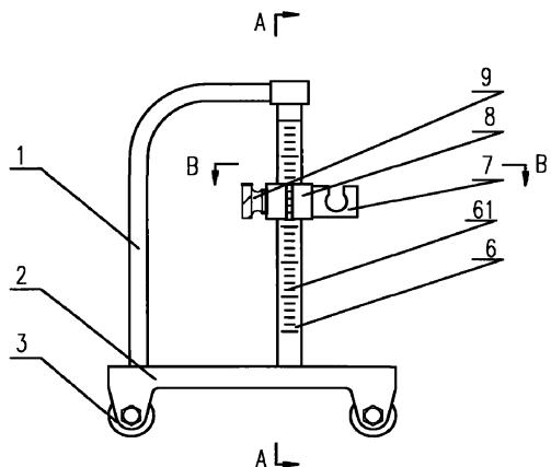
1、一种调修火枪用活动支架，具有一底座（2），在底座（2）下部设置有滚轮（3），在底座（2）上方垂直地连接有一导杆（6），其特征在于：在所述的导杆（6）上套设有一高度调节滑块（8），锁紧螺杆（7）水平地贯穿于高度调节滑块（8）并通过内、外螺纹相互啮合连接；
