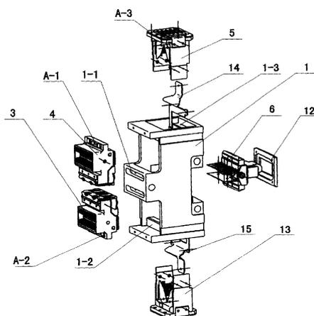
1、一种模块式电流断路器，由一组柱极组合构成，所述柱极装有用于控制电流通断的动、静触头，用于引导电弧的引弧片以及用于熄灭电弧的灭弧室，其特征在于：所述柱极为一内部形成空腔的整体壳架，所述壳架安装触头、以及引弧片和灭弧室的对应面分别开有插装口，所述插装口中设有与对应安装件相配的固定结构；所述柱极壳架的左右面为闭合面，分别在对应前面横挡和后面插装孔两旁的位置制有三个穿孔，组装时三根横杆分别穿过一组中各柱极的所述三个穿孔，并借助两侧壁板的夹持构成断路器整体。
