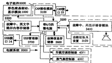
1. 车用实时智能故障监测仪，包括液晶驱动显示模块、电子组件电路板以及为两部件供电的电源系统，其特征在于电子组件电路板包括带 A/D 转换的微处理器以及分别与微处理器线路连接的 CAN 总线智能接收模块、故障中英文提示内容存储器、故障提示语音模块、功能切换及设置电路、故障信息存储器，液晶驱动显示模块的 I/O 口与电子组件电路板的 I/O 口相连接通带 A/D 转换的微处理器，所述的 CAN 总线智能接收模块由 CAN 接口连接汽车传感器处理部件。
