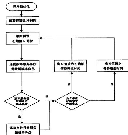
1、一种在计算机系统中使用的软件升级方法，所述计算机系统包括版本服务器、文件升级服务器、客户机，所述版本服务器、所述文件升级服务器、所述客户机互相连接，所述版本服务器设置有软件的最新版本信息数据，所述文件升级服务器设置有软件升级数据，所述客户机设置有用于升级的客户端程序，其特征在于所述方法包括以下步骤：设置步骤、连接步骤、比较步骤、升级步骤、判断步骤，即
