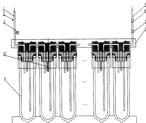
1、一种全天候无水箱承压式太阳能热水器，主要包括集热管(4)、热水管(1)、冷水管(5)，其特征是：若干根玻璃真空集热管(4)经“L”形接插导流管(9)串联成集热器，第一根集热管的冷水进水管(5)上设有止回阀(6)和压力开关阀(7)，末尾集热管的热水出水管(1)上串接一泄压安全阀(3)，末尾第一至第四其中任意一根集热管内插有温度传感器(21)；
