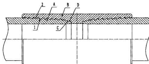
1、一种高密封锯齿螺纹套管连接结构，它由一个端部带有外螺纹的套管与端部带有内螺纹的接箍旋合拧接而成，其特征是：
