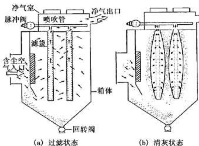
图 6.1-1 布袋除尘器原理示意图
