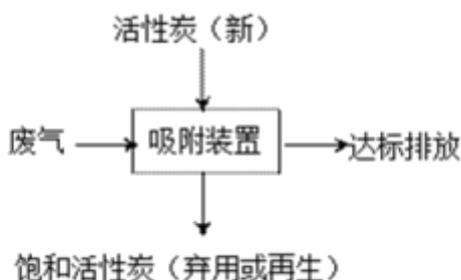
图 6.1-3 活性炭吸附装置处理工艺流程图
