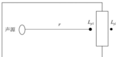
①首先计算出某个室内靠近围护结构处的倍频带声压级
