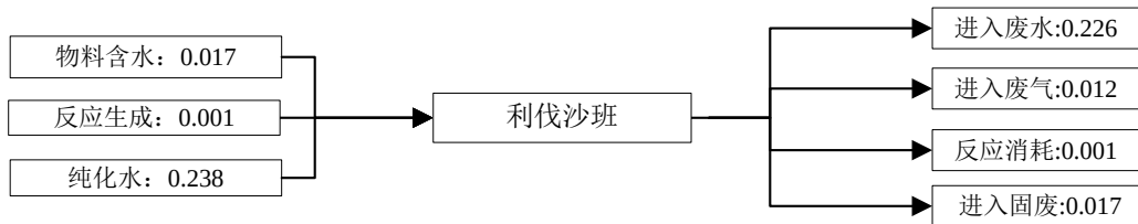
图 4.1.1-8 利伐沙班生产工序水平衡示意图单位： m³/d
