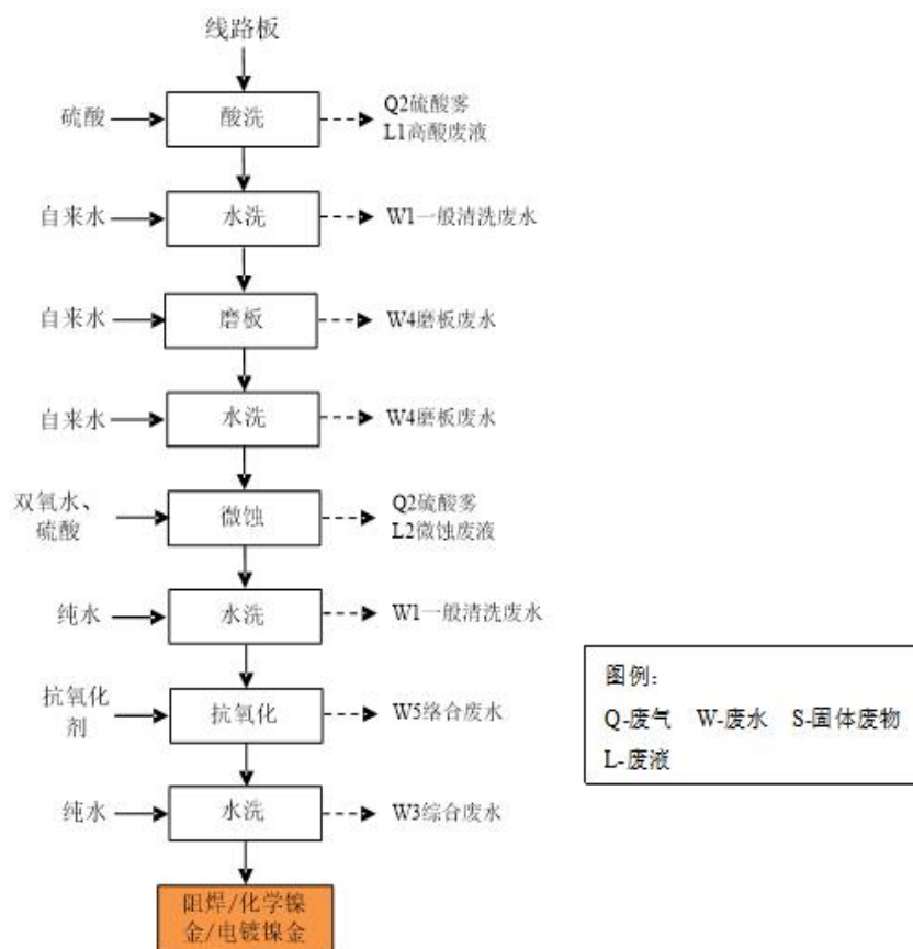
图 11 磨板工艺流程及产污节点图
