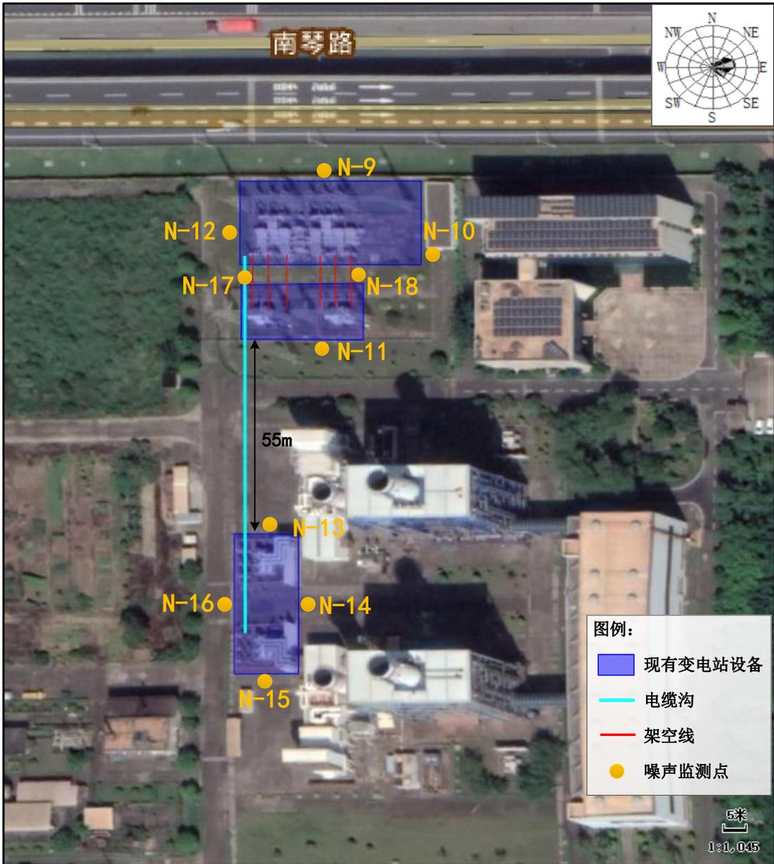
图 3-4 现有变电站、架空线噪声监测布点图
