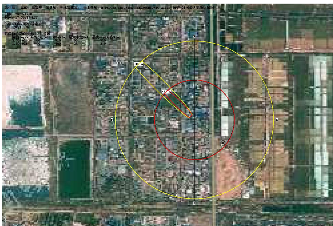
图 5.7-1 (6) 氯代特戊酰氯包装桶泄漏事故最不利气象影响区域图 (红线：终点浓度 1；黄线：终点浓度 2)
