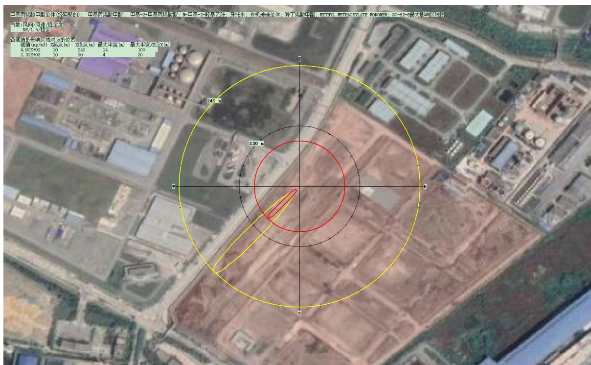
图 6.6.4.3-5 甲基丙烯酸甲酯泄漏事故最大影响区域图（最不利气象）
