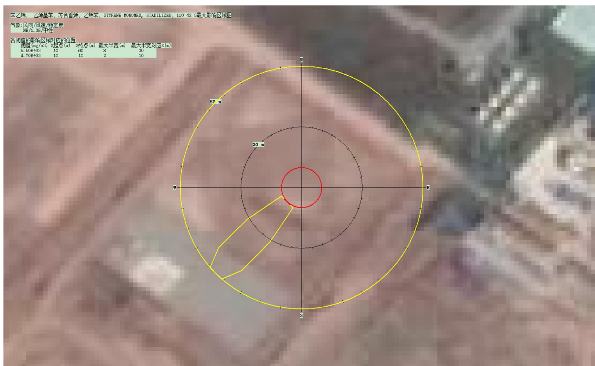
图 6.6.4.3-22 苯乙烯泄漏事故最大影响区域图（常规气象）
