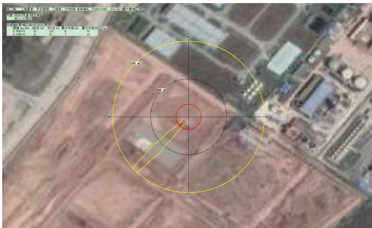
图 6.6.4.3-21 苯乙烯泄漏事故最大影响区域图（最不利气象）
