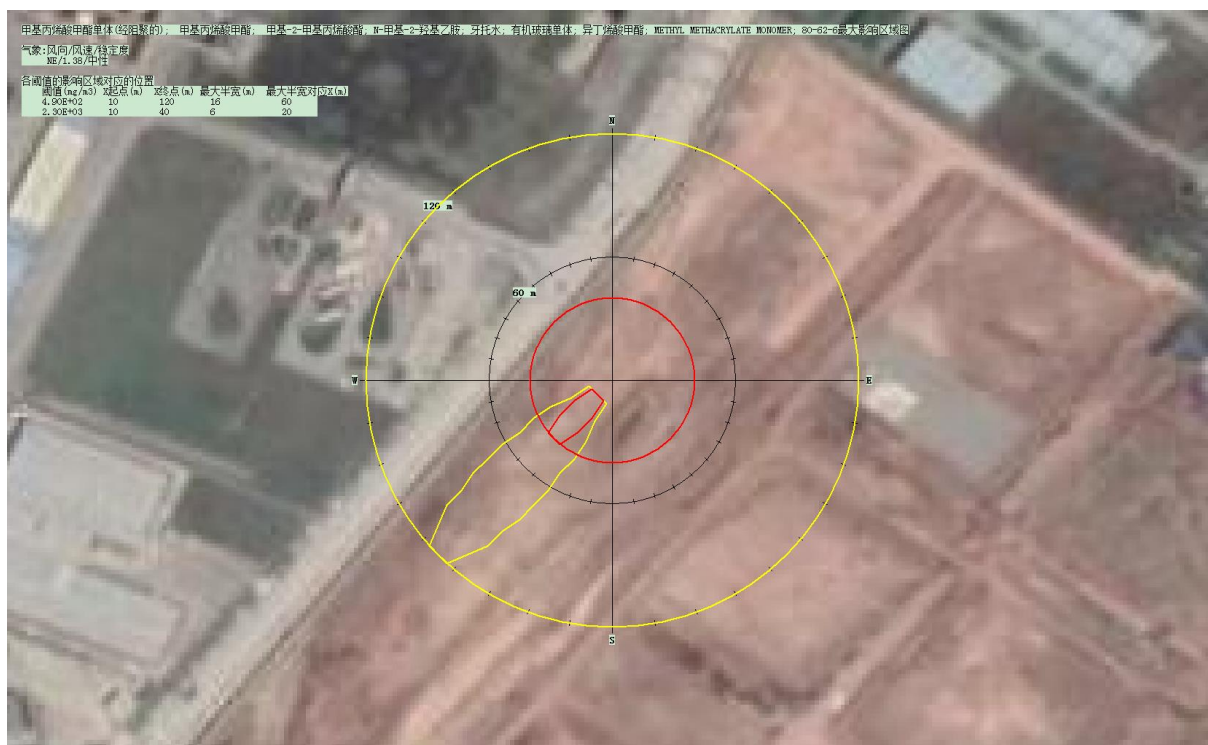
图 6.6.4.3-6 甲基丙烯酸甲酯泄漏事故最大影响区域图（常见气象）
