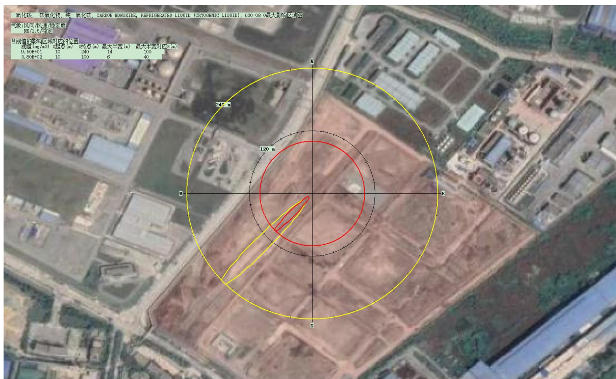
图 6.6.4.3-13 最不利气象条件下苯乙烯储罐火灾伴生 CO 影响区域图
