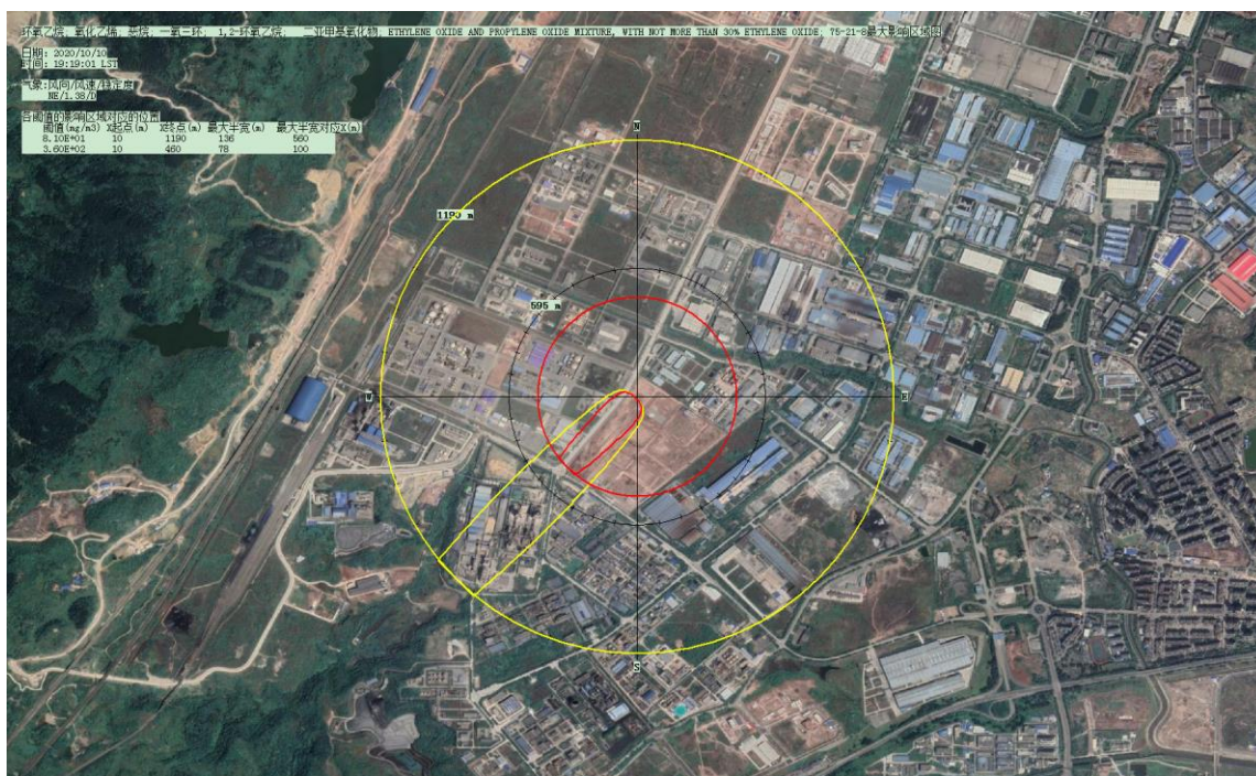
图 6.6.4.3-2 环氧乙烷泄漏事故最大影响区域图（常规气象）
