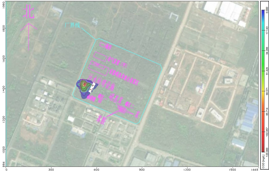
图 8.3-5 污染物 COD 污染晕运移分布图 第 1000 天
