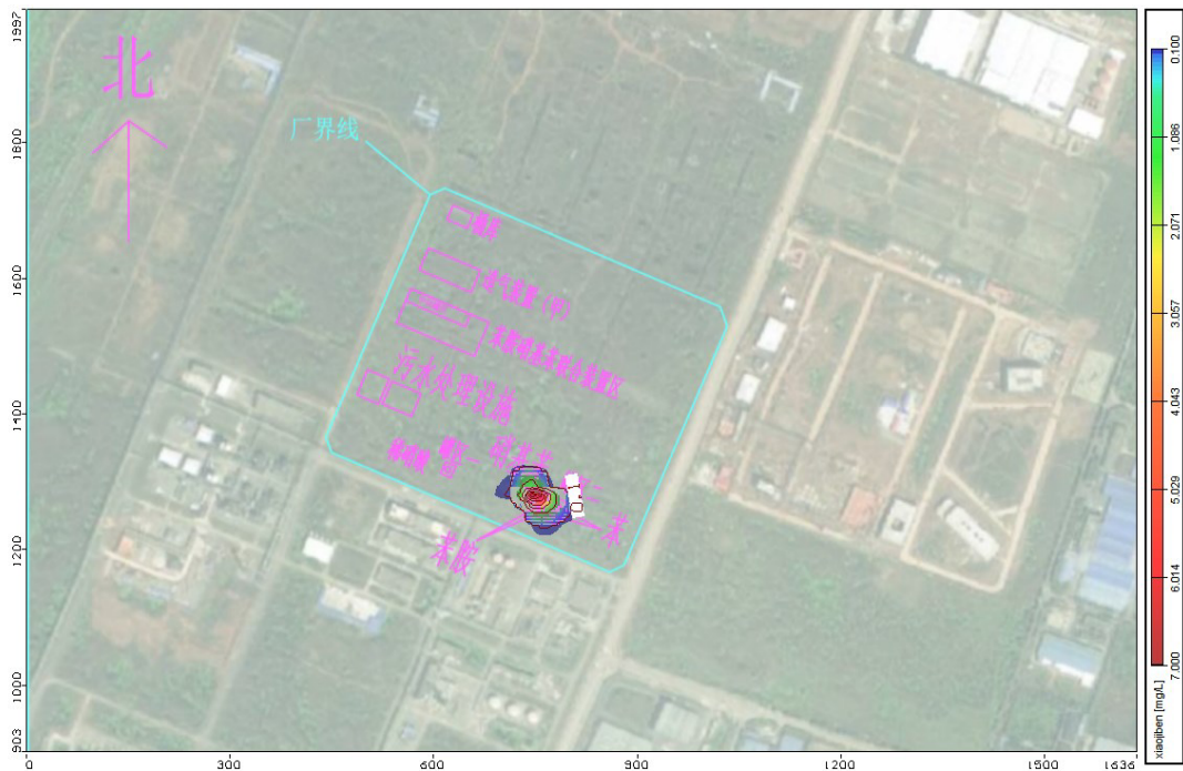
图 8.3-14 污染物硝基苯污染晕运移分布图 第 1000 天
