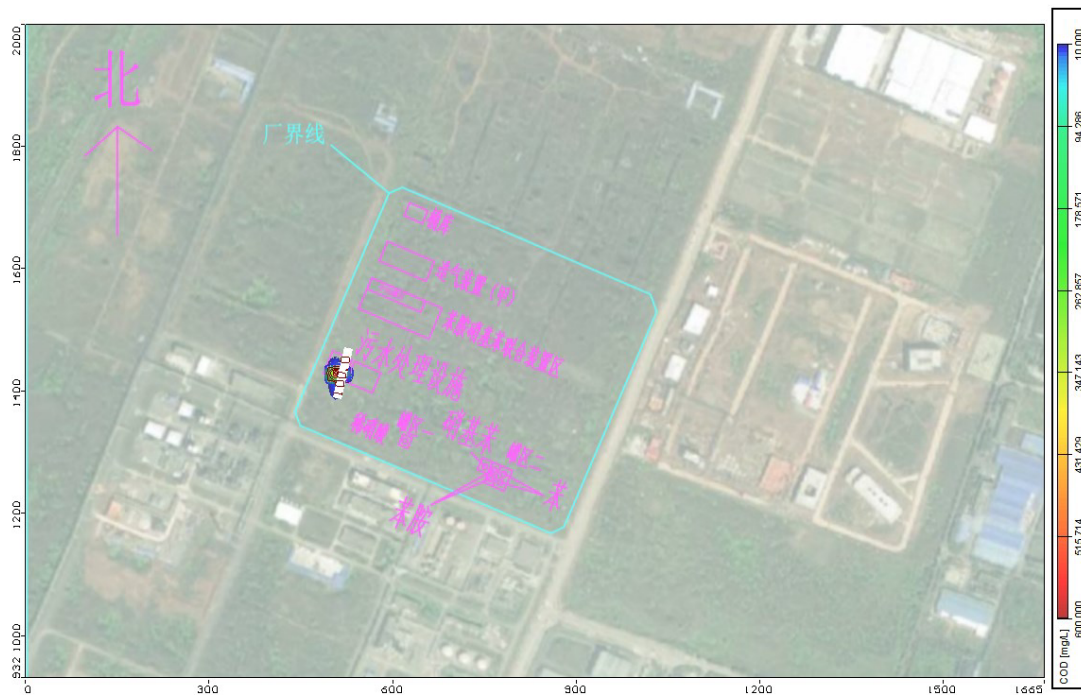
图 8.3-4 污染物 COD 污染晕运移分布图 第 100 天
