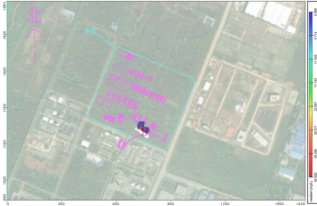
图 8.3-13 污染物硝基苯污染晕运移分布图 第 100 天
