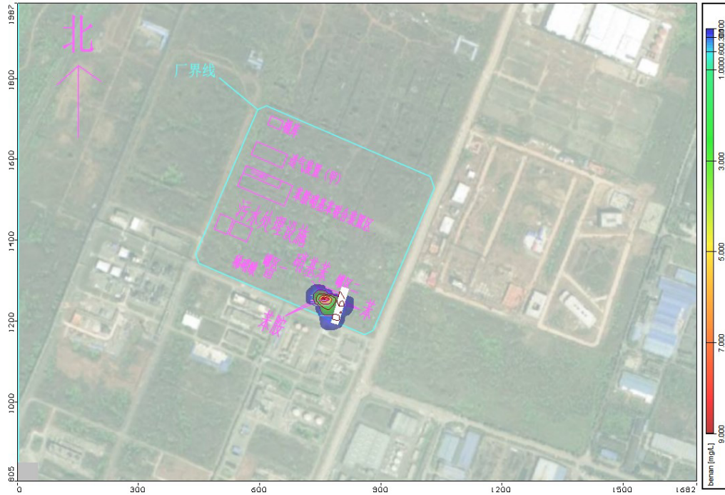
图 8.3-11 污染物苯胺污染晕运移分布图 第 1000 天
