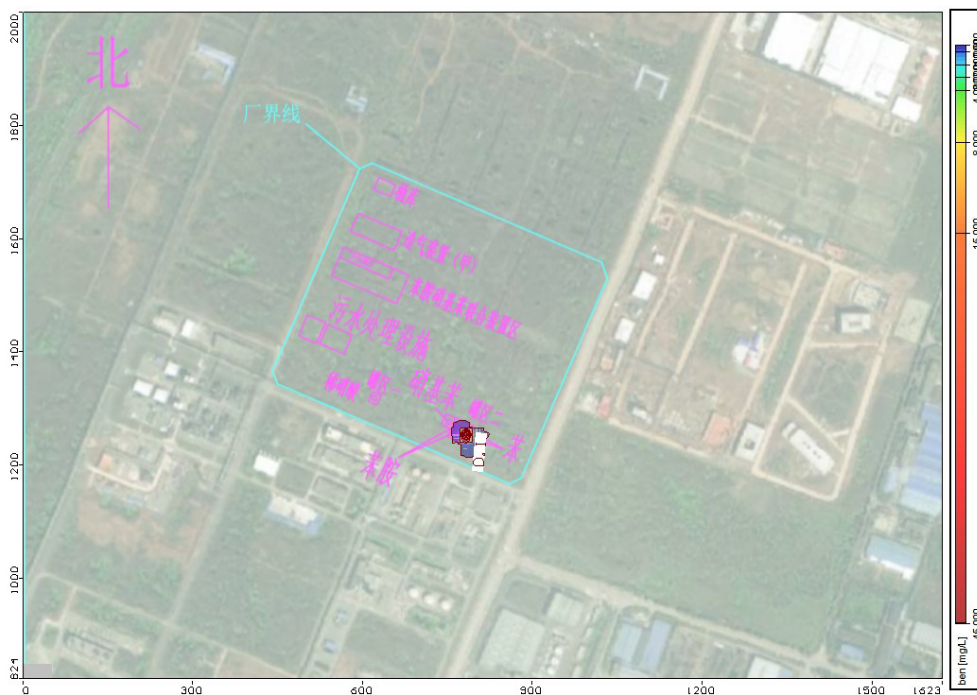
图 8.3-7 污染物苯污染晕运移分布图 第 100 天
