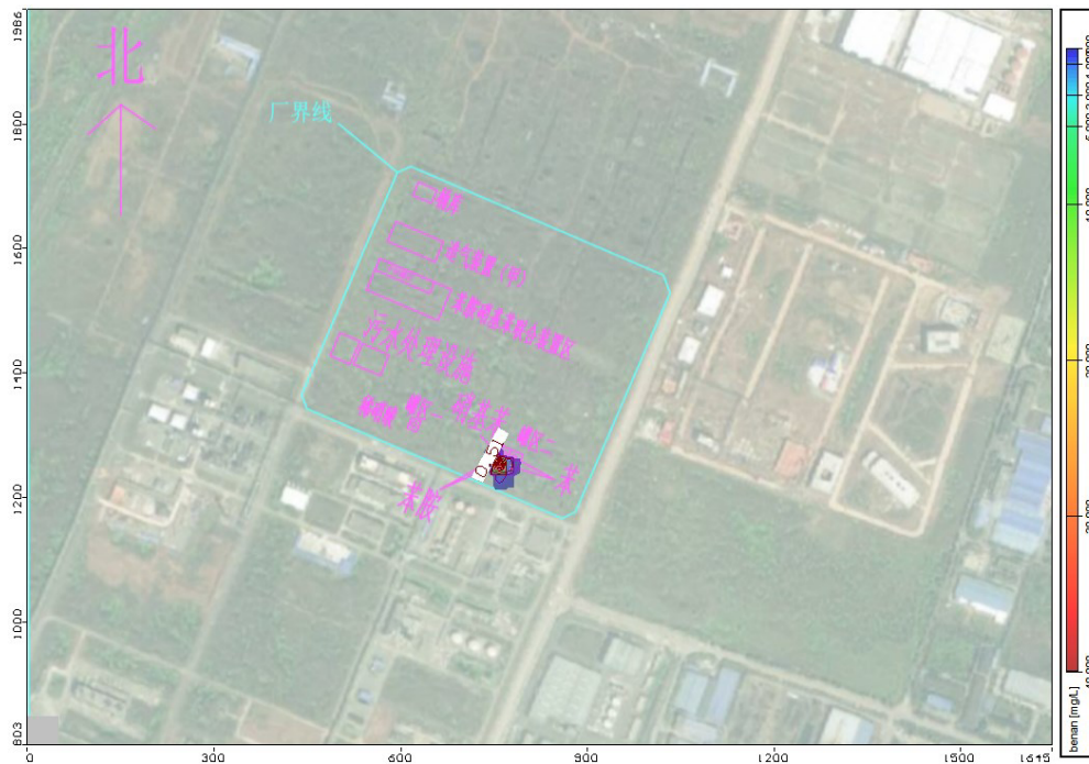
图 8.3-10 污染物苯胺污染晕运移分布图 第 100 天
