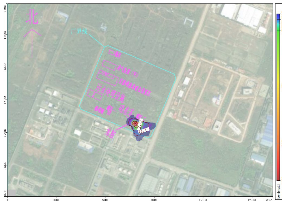
图 8.3-8 污染物苯污染晕运移分布图 第 1000 天
