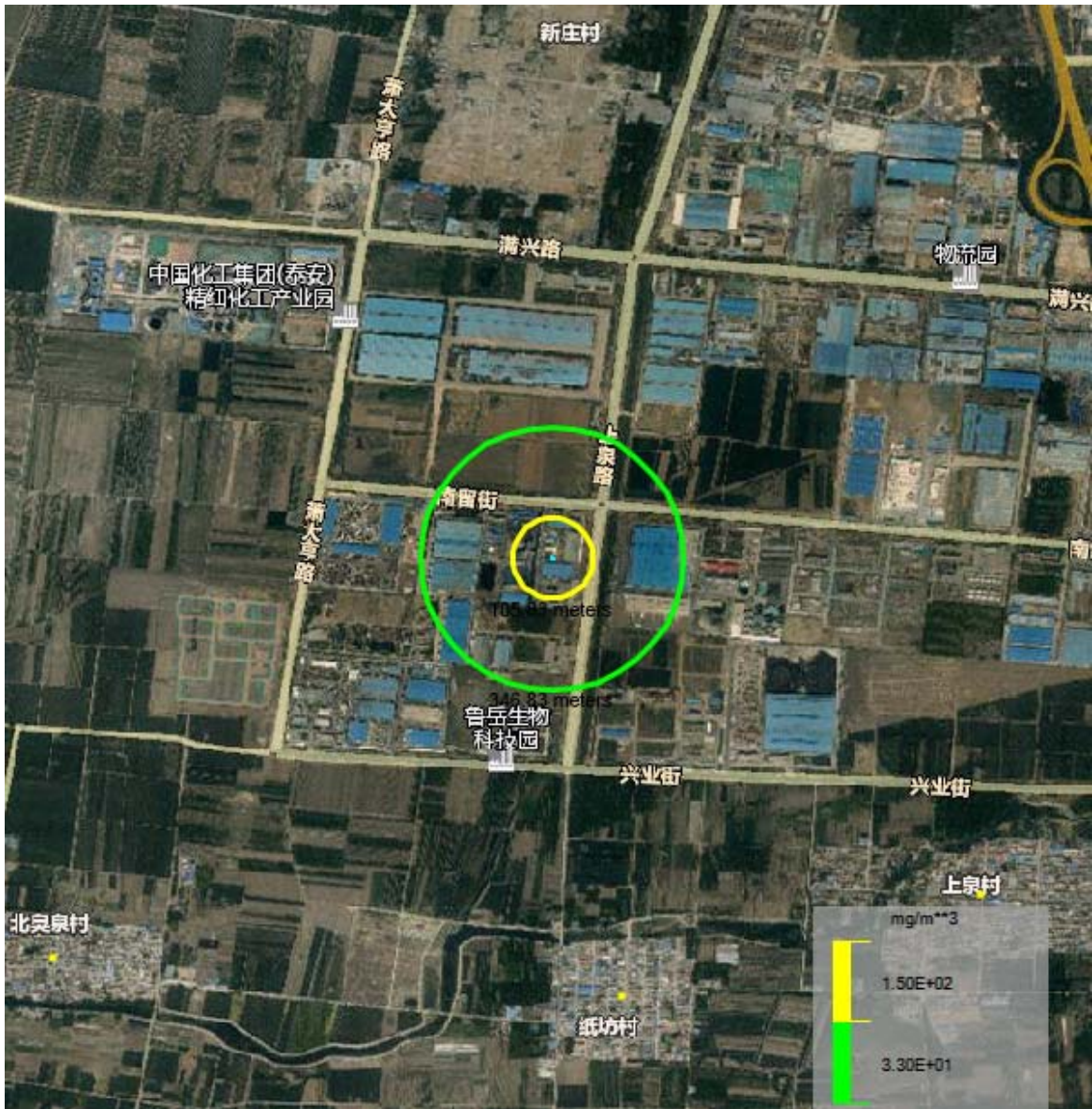
图5.8-3 氯化氢毒性终点浓度最大影响范围图（黄线-毒性终点浓度-1-33mg/m 3 ，绿线毒性终点浓度-1-150mg/m 3 ）（最不利气象）
