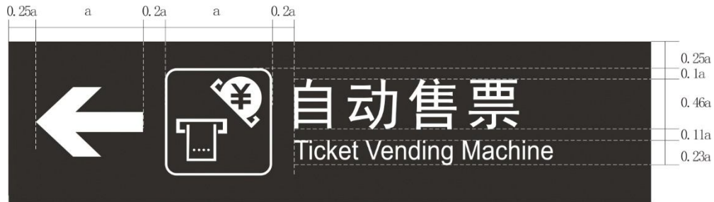
图7 标识中图形符号、单排文字规格示意图
