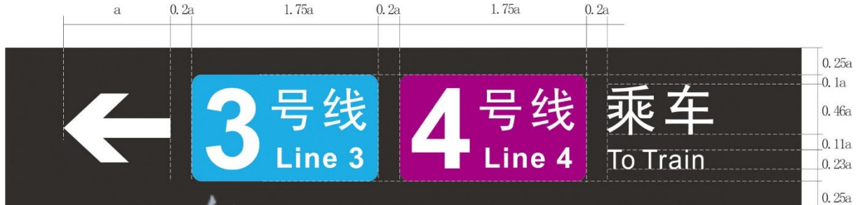
图15 多线路标识与图形符号、文字及其与标识边缘的距离要求（站台乘车导向标识）
